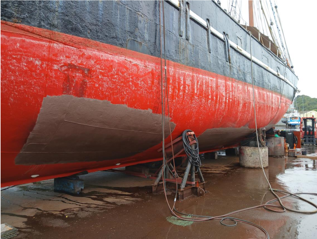
Die reparierten Schadenstellen
