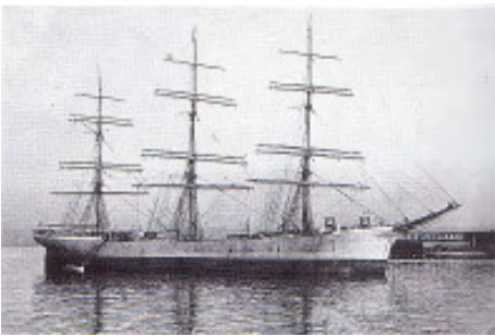
Abb.: Vollschiff PERU, der letzte Neubau der BSG, 2024 BRT, Länge: 82,3 m, Breite: 12,3 m. 1914 in Liverpool als FRITZ beschlagnahmt, am 7.2.1917 durch U6 versenkt.
